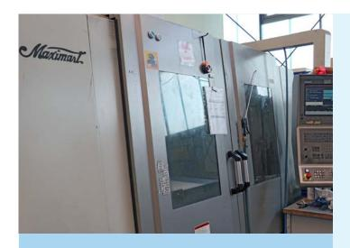
Auch im Alter äußerst produktiv: Julian Wiegold rüstete das Bearbeitungszentrum Maximart VMC 105, Baujahr 2004, mit Vakuumspannsystem und KNOLL AerosolMaster auf. Beim Bearbeiten von Aluminiumplatten bringt sie nun Höchstleistungen.
