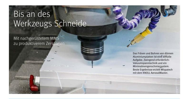
Auch ältere Werkzeugmaschinen profitieren von einem nachgerüsteten Minimalmengenschmiersystem (MMS) – insbesondere, wenn es sich um Aerosol-Trockenschmierung (ATS) handelt. Das bestätigt auch Julian Wiegold, Zerspanungsprofi und Inhaber von Wispatech in Kaltenkirchen. Mit dem KNOLL Aerosol-Master gelang es ihm, auf einer fast 20 Jahre alten Maschine beim Bohren und Fräsen von vakuumgespannten Aluminiumplatten die Bearbeitungszeit um bis zu 50 Prozent zu reduzieren.
