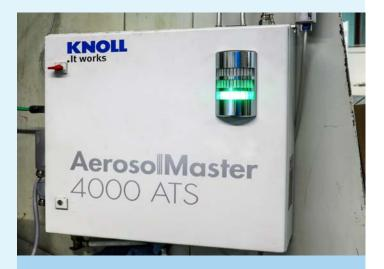
Die Besonderheit der AerosolTrockenschmierung ist, dass feines Aerosol mit einer durchschnittlichen Tröpfchengröße von 0,25 µm erzeugt wird. Deshalb ist selbst bei hohen Drehzahlen und auf langen Distanzen eine Entmischung des Aerosols kaum zu erwarten.
