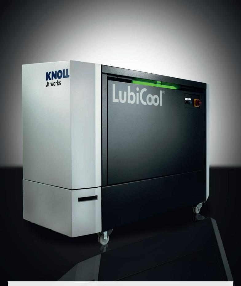
Der LubiCool® ist eine mobile Hochdruckanlage für spanabhebende Werkzeugmaschinen, insbesondere Kurz- und Langdrehautomaten. Sie dient zur Reinigung des Kühlschmierstoffs und zur Versorgung der Maschine mit Hochdruck.
